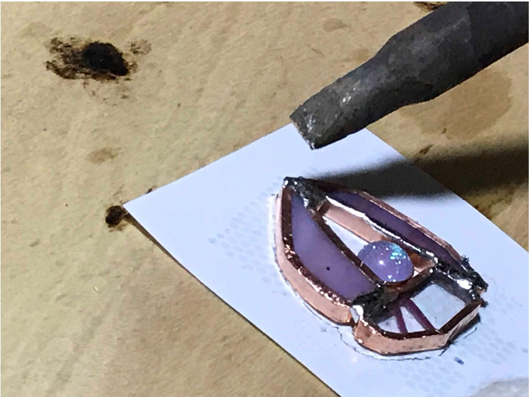
裏表半田付けが完了したら、丸環を半田付けします。
